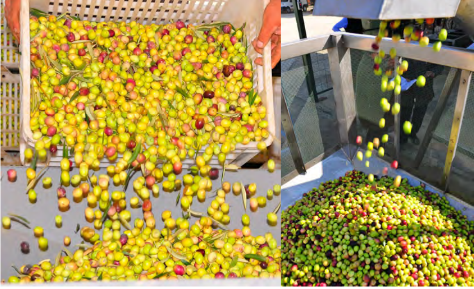
Sıkımdan önce zeytin tanelerinin yaprak ve diğer istenmeyen maddelerden temizleme işlemi.
