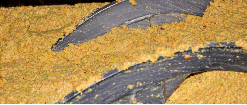
Malaksörde karıştırılan zeytin hamuru
