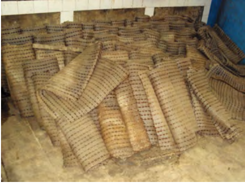
Sulu baskı sisteminde kullanılan tahsир torbaları
