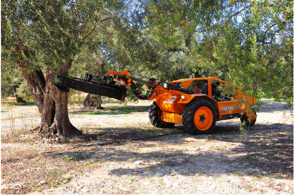
Edremit Yöresi’nde kullanılan modern hasat makinesi. İşçilik ve zamandan büyük tasarruf sağlayan bu makine ağacı gövdesinden kavrayıp titreşim oluşturarak taneleri yere döker (Altınova – Ayvalık)
