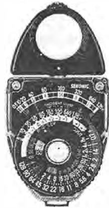
Gelen ve yansıyan ışık ölçümünde kullanılabilen bir ışıkölçer.
