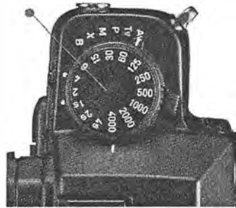
Fotoğraf makinesinin üzerindeki obtüratör (enstantane) ayarının yapıldığı düğme.
