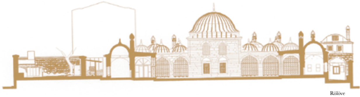
Şekil 6: Evvel Medrese, rölöve ve restitüsyon B-B kesiti
