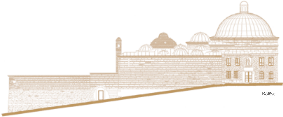
Şekil 29: Hamam, rölöve, 16. ve 19.yy restitüsyonları batı cephesi
