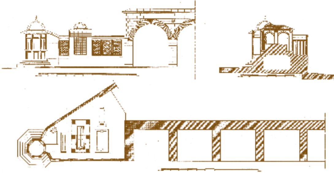
Şekil 7: Mimar Sinan Türbesi plan, cephe ve kesiti (A. Saim Ülgen)
