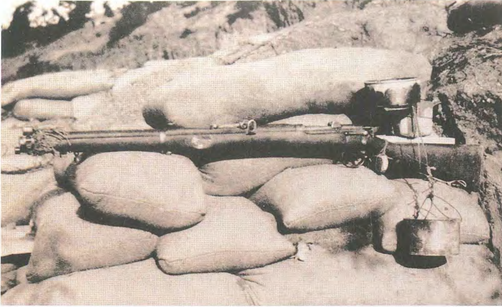
Gelibolu Yarımadası'ndan çekilen Anzakların siperlerde bıraktıkları kendiliğinden patlayan tüfeklerden biri. Üst kaptaki suyun damla damla alt kaba akmasıyla ağırlık artmakta tetiğe baskı sonucu tüfek patlamakta. (1915)
