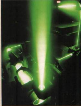
Kusursuz olması gereken ayna ve merceklerin yapımı sırasında, hataları tespit etmek için lazer ışınlarından yararlanılır.
