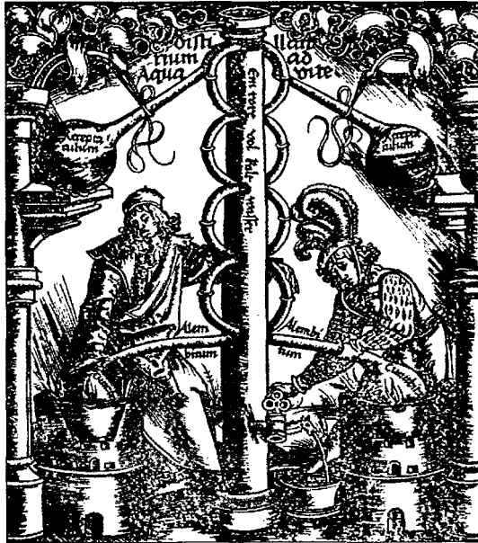
Şekil 83: Ayrımsal damıtmayla alkol artıtımı (1526).
