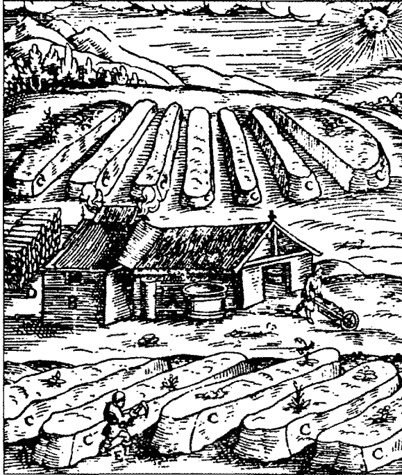
Şekil 86: Lazarus Ercker'e göre 16. yy'da güherçile bahçelerinden güherçile eldesi (1574):
