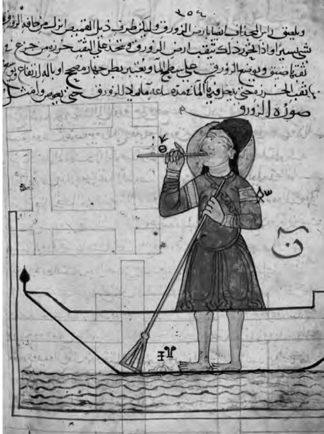
El-Cezeri'nin Bilgi Kitabı'ndan alınan resimdeki bu minyatür, suyla çalışan ve flüt oynatan makineyi betimliyor. Cezeri bizzat kendisi bu makineyi hareketli aların saati olarak tarif ettiğini söylüyor. Uyuyan kişiyi uyandırmak amacıyla tasarlanan bu makine işlevini yerine getirmek için hafif bir ses çıkartıyor. Topkapı Sarayı Müzesi, İstanbul.
