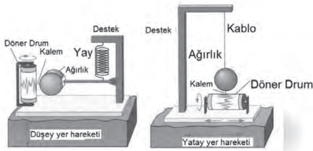
ŞEKİL 1: Düşey ve yatay doğrultulardaki yer hareketlerini ölçen sismografların şematik gösterimi [4].
