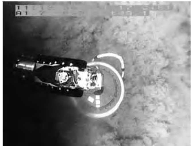
Nautila, deniz tabanındaki siyah noktadan gaz örneği alıyor. Sağdaki karede ise deniz tabanına Okyanus Tabanı Sismografı (OBS) yerleştiriyor
