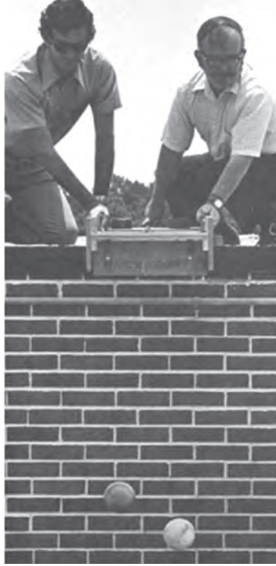
Şekil 1. Yazarlar, Coulter (solda) ve Adler (sağda), 12 ve 1/4 librelik aynı boyuttaki iki topu, 10 katlı bir binanın tepesinden bıraktılar. Burada, toplanı bırakma aparatının deneysel hatasının belirlenişi gösterilmektedir.
