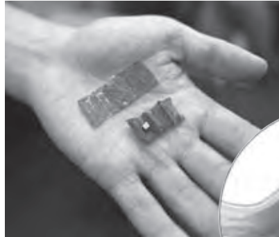
Kırıstırılmış bir kağıt parçasına benzeyen mikrorobot, ısıya ve manyetik alana maruz kaldığında genişleyen ve küçülen materyale stratejik olarak yerleştirilmiş yamalar, kıvrımlar ve yarıklar marifetiyle hareket ediyor.
