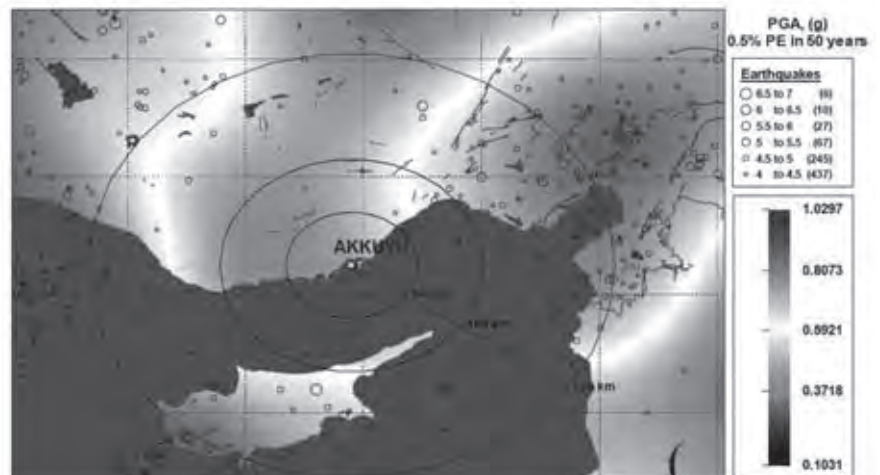
Şekil 5. 50 yılda % 0,5 aşılma olasılığında (9975 yılda tekrarlama olasılığı) Akkuyu ve çevresinin etkilenebileceği Olabilecek En Büyük Deprem (MCE) ivme değerleri dağılımı. İvme değerleri g olarak verilmektedir. 1 g = 981 cm/sn 2 dir. (12)
