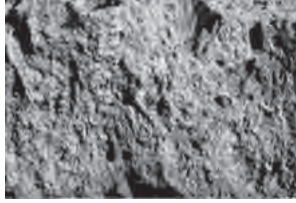
Eriyonit mineralleri içeren pomza parçalı volkanik tuf kayası (Tuzköy-Gölşehir) ve eriyonit mineral iğneciklerinin taramalı elektron mikroskop (SEM) görüntüsü
