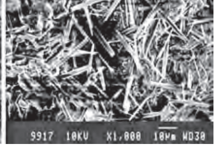
Eriyonit mineralleri içeren pomza parçalı volkanik tuf kayası (Tuzköy-Gölşehir) ve eriyonit mineral iğneciklerinin taramalı elektron mikroskop (SEM) görüntüsü
