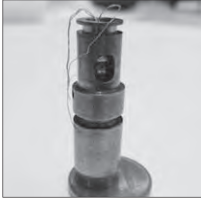
Bu ortasından bölünmüş bakır-titanyum kaplama, maddeleri muazzam bir basınçla ezen iki elmas içeriyor. Bu aparatdaki deneyler gösterdi ki, bir hidrojen sülfür bileşimi kısmen yüksek sıcaklıklarda süperiletken olabilir.
