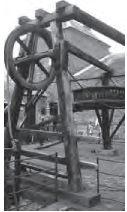
Cevheri ve suyu çıkarmak için pompalar ve yük kaldırma makaraları (çıkırıklar ve vidalar) kuruldu.
