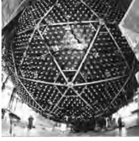
Fotoğrafta, Sudbury Nötrino Gözlemevi görülüyor. Merkezde, devasa dedektör yer alıyor.
