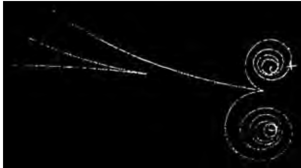
Şekil 1. Lawrence Radiation Laboratuvarında hidrojen kabarcık odasında (hydrogen bubble chamber) Luis Alvarez tarafından çekilmiş bu fotoğraf gamma fotonunun elektron pozitron çiftine ayrıldığını gösteriyor (Charles Kittel, W.D. Knight & M.A. Ruderman, Mechanics , Berkeley Physics Course, Vol. 1, 1965).
