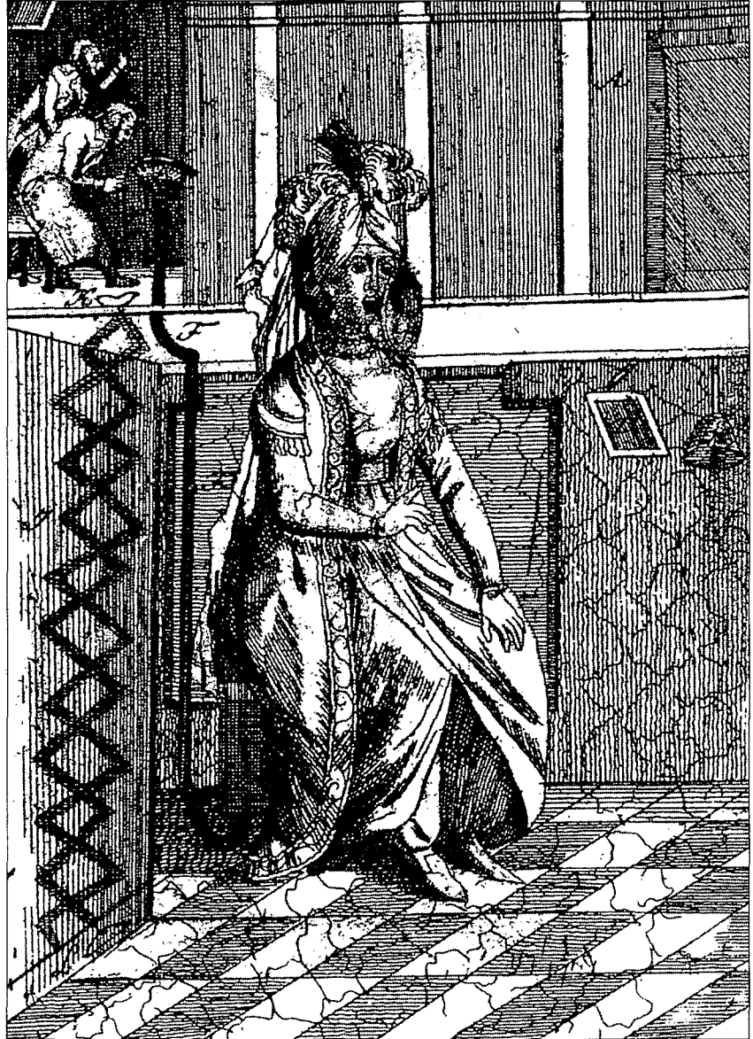
ŞEKİL 28. Konuşan android: Burada androidin sözlü iletişimi, antik ön modellere göre gerçek kişiler tarafından borular aracılığıyla taklit edilmektedir. Sol tarafta görülen düşey yerleştirilmiş makas kurgusu, olasılıkla figürün çeşitli organlarını hareket ettirmeye yaramaktadır [D. Brunner, Sprechmaschinen , Nürnberg, 1798].
