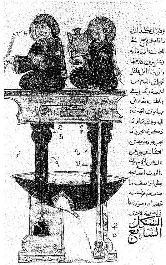
SEKİL 20. El-Cezerî'den, kan alma (hacamat) sırasında akan kan miktarını ölçen otomat: Kan alma sırasında alınan kan miktarını ölçmede kullanılabilecek bu tıbbi düzende akan kan bir leğende birikirken, atan kan ağırlığı bir makarayı çalıştırır ve bu hareket, yukarıdaki iki kâtipin dönme hareketine yol açar. Kâtiplerden biri derecelendirilmiş bir daire üzerinde işaretlenmiş bir noktayı gösterirken, diğeri aynı tarzda, bir yazı levhası üzerine not alır (El-Cezerî'nin eserinin 1315 tarihli Suriye kopyasından, Freer Gallery, Washington)
