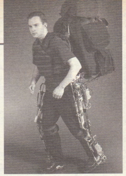
Robot destek sistemleri sayesinde kişinin taşıyabileceği yük 32 kg artırıyor.
