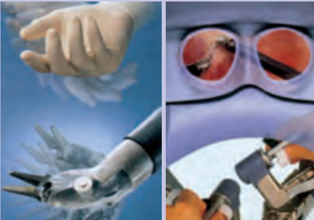
"da Vinci Cerrahi Sistemi"nde cerrah, robotun kollarını özel bir konsoldan (en üstte) yönetiyor. Cerrah, robotun kollarına yaptırdığı her hareketi izleyebiliyor (sağda en altta). Robotun kolları, bir insanın el hareketlerine benzer biçimde çalışıyor (solda en altta).
