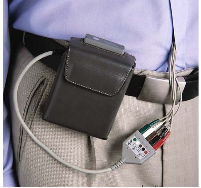
Taşınabilir elektrokardiyograflar sayesinde kalp etkinlikleri bir gün boyunca ölçülebiliyor.
