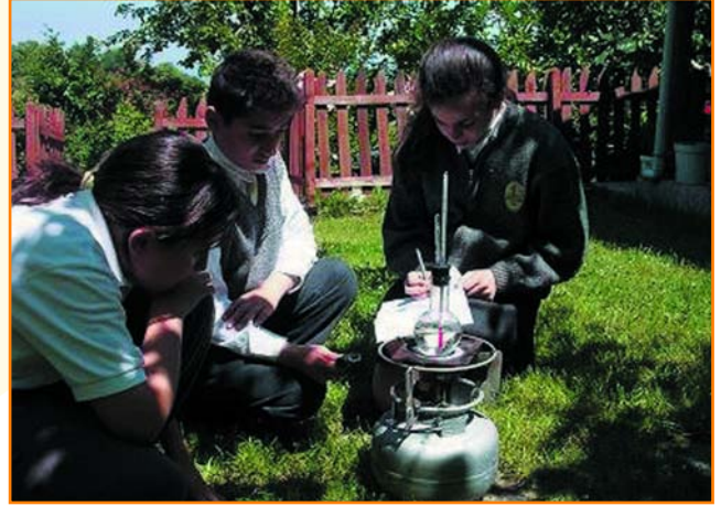
Yalova Öncü İÖO öğrencileri, deniz seviyesine yakın, 5 metrede kaynama sıcaklığını 100°C olarak bulmuşlar.
