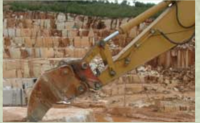
Üstteki mostra tabakası temizlendikten sonra, kayadan büyük bloklar kesilir.
