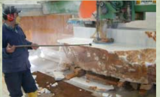
Kesilen bloklar, fabrikada istenilen büyüklüklerde yeniden kesilir ve parlatılır.
