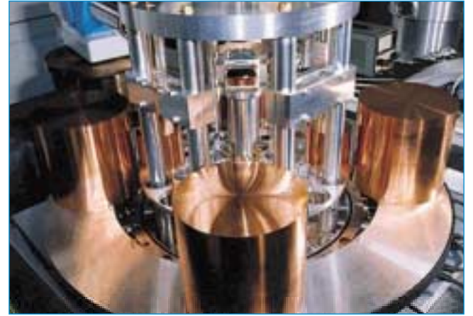
Cavendish'in, kütleçekim sabitini bulmak için kullandığı deney düzeneğinin modern örneği.
