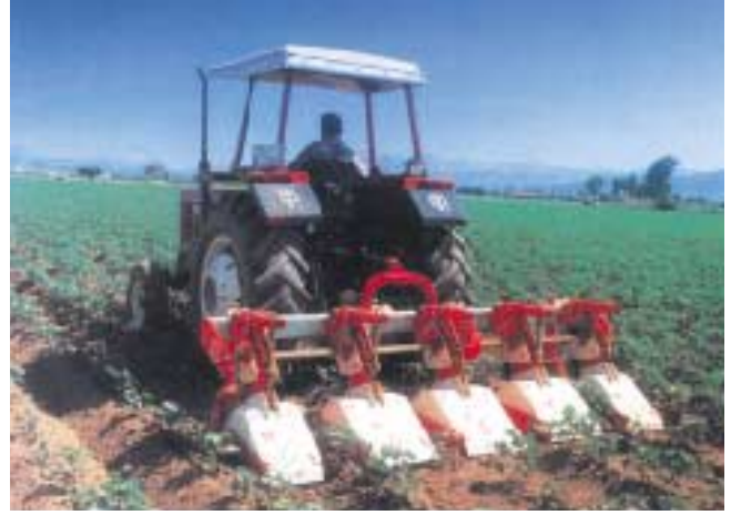
Frezeli ara çapa makinesiyle ekili bitkilerin arasındaki yabancı otlar, bitkiye zarar vermeden toplanıyor. Ayrıca, bu makine bitkilerin gereksinim duydukları besin öğelerini ve suyu topraktan rahatlıkla alabilmeleri için ortamı da yaratıyor.
