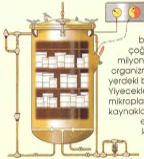
Yüksek basınca dayanıklı bir kapağı olan otoklav sayesinde kutular çok yüksek sıcaklıklara kadar ısıtılabilirdi.
