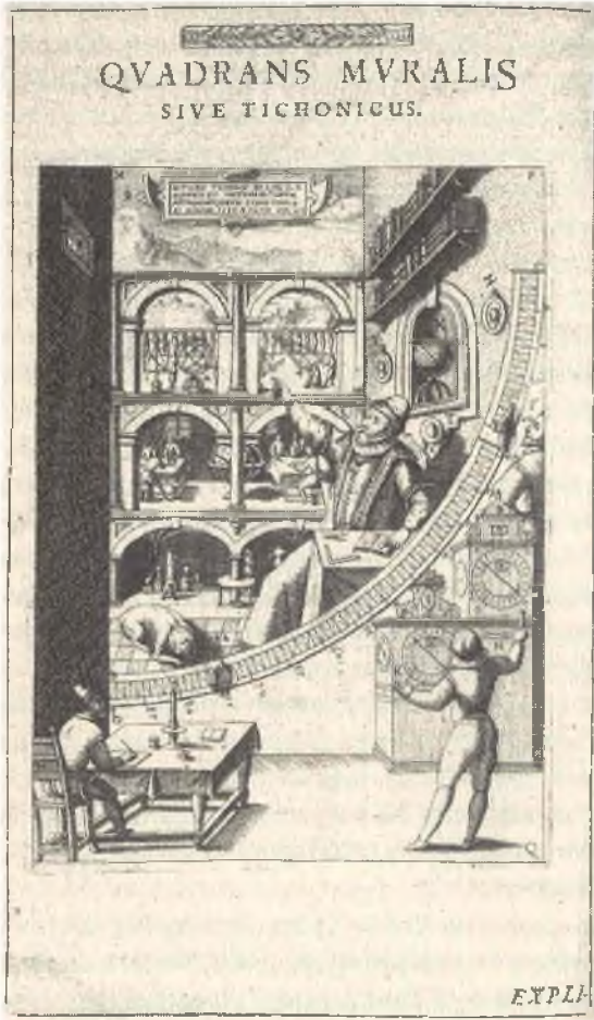
ŞEKİL 15 Tycho Brahe'nin duvara çizili çeyrek yayı. Tycho Brahe, Astronomiæ instauratiæ mechanica (Yeni Astronominin Makineleri, 1587)
