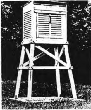
Şekil 1.3. Hava sıcaklıklarının ölçüldüğü meteoroloji alet siperi (Ahrens, 1988).
