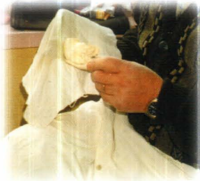
856 - 857 Ustanın balmumundan çıkarılan pipo başlarını bezle parlatışından bir ayrıntı.
