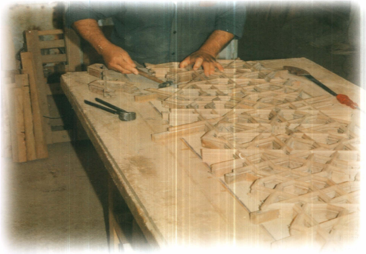
210 - 211 Kündekâri tekniğinin Mevlüt Çiller tarafından uygulanışı ve ustanın yaptığı bir kündekâri tavandan ayrıntı.
