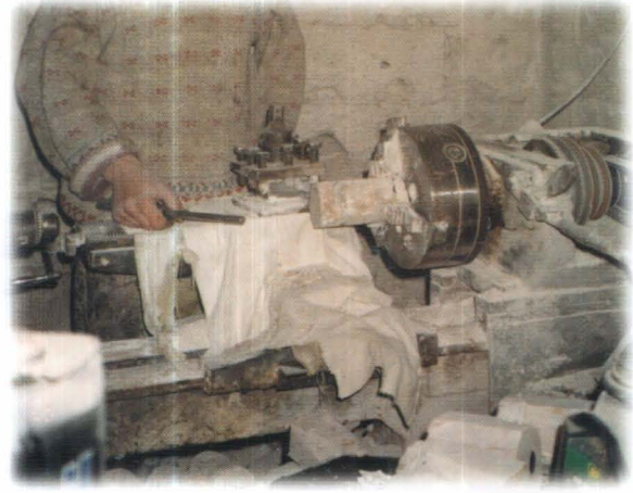
871 - 872 Kırşehir'de ustanın kalemlige taktığı elmas kalemle tornada vazo yapışından ayrıntılar.
