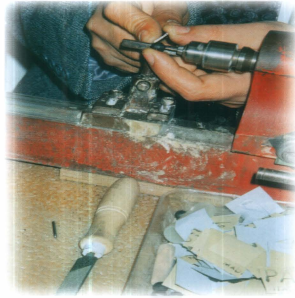
298 Tespih tanesinin yapılışı ve torna tezgahı başında tane yuvarlanması.
