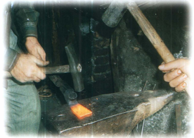
690 - 691 Beypazarı'nda sıcak demir işçiliğı yapan ustanın işliğinde tavlanmış demiri dövüşünden ayrıntılar.
