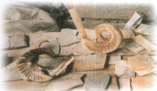
303 Aynı işlikten işlemeğe hazırlanmış ve tarak yapılmış boynuzlar.
