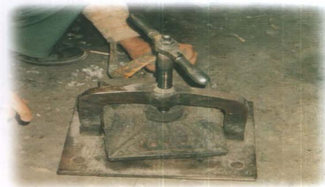
300 - 301 - 302 Boynuzu işkenceye sıkıştırılışı ve tarağa dış açılışı.
