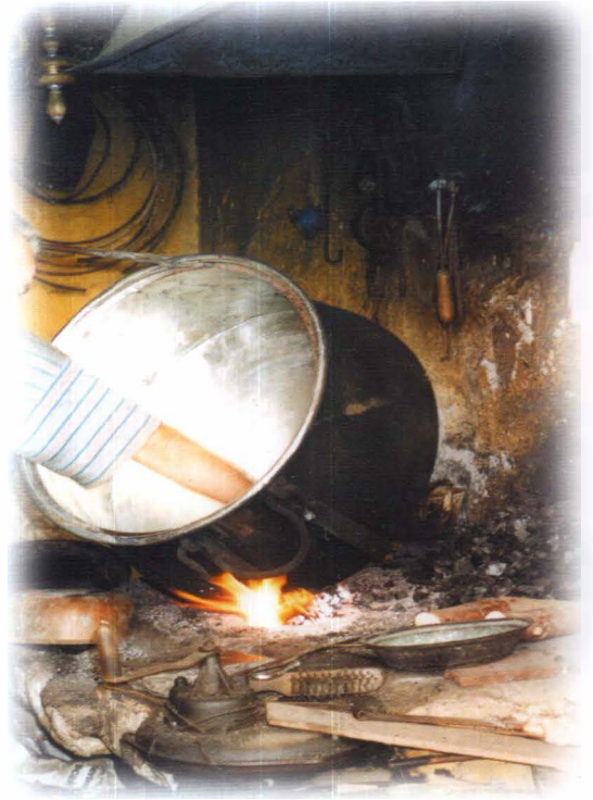
728 - 729 Ustanın kazan kalaylayışından ayrıntılar.
