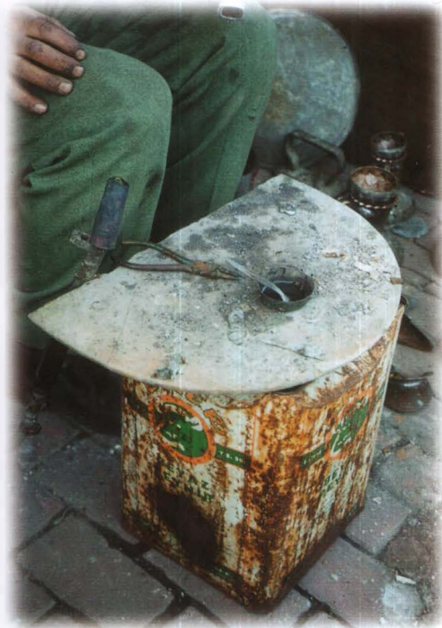
732 - 733 Kalayla lehim yapan bir ustanın uygulamasından bir ayrıntı.
