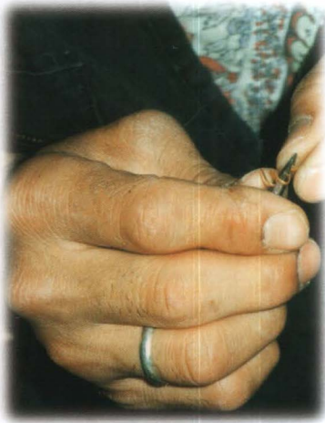
708 - 709 - 710 - 711 Beypazarı'nda yapılan telkârî işinde tek tek tellerin biçimlendirilişi, kaynaklanışı.
