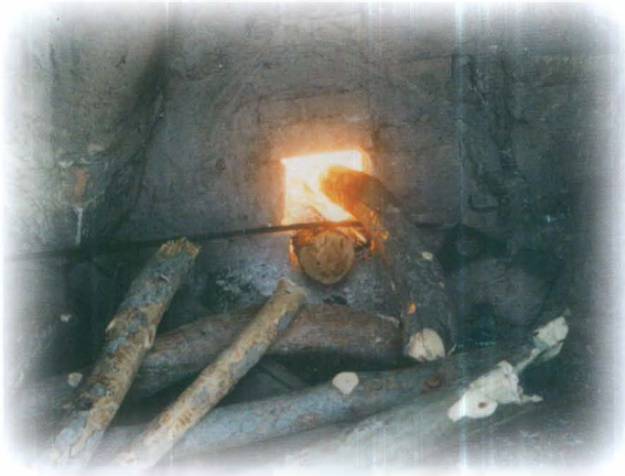
314 - 315 İzmir, Görece'deki bir ışikten cam fırınının ağzı ve demiryolu rayı biçimindeki bir tezgâhtan bir cam çubuğu.
