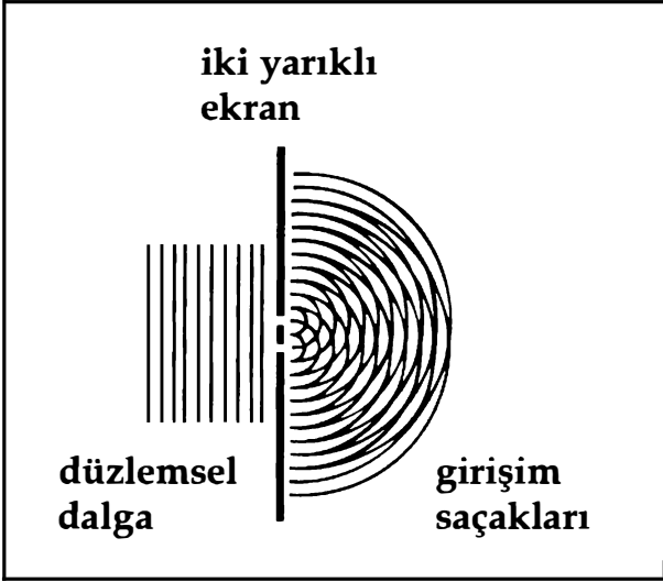
Resim 6: Üzerine iki tane yarık açılmış ekrana çarpan düzlemsel bir dalga, ekranın diğer yanına iki kaynaktan yayılan ve kesişen dalgalar olarak geçer ve birbiri ardına oluşan aydınlık ve karanlık saçaklar üretir.
