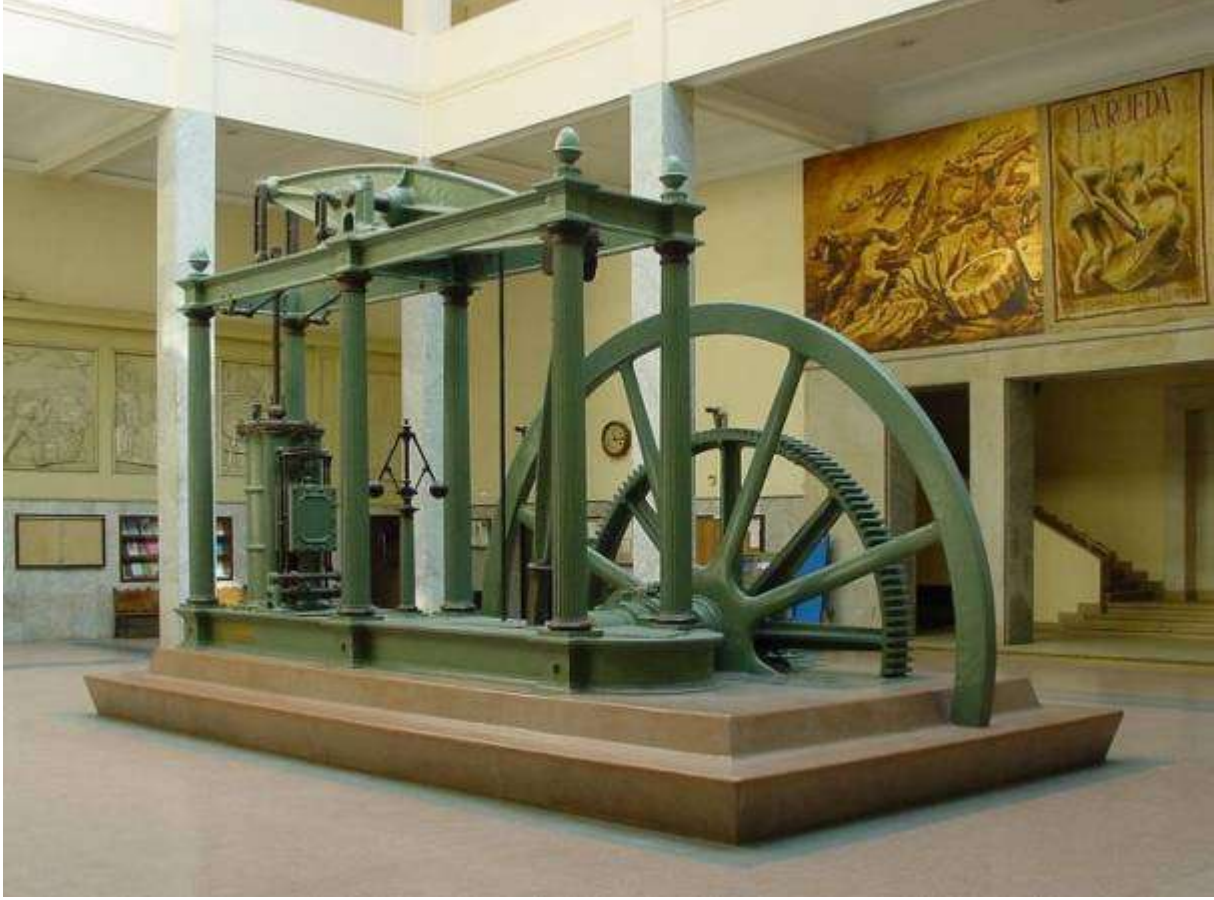
Watt'ın iki zamanlı buhar makinesi
