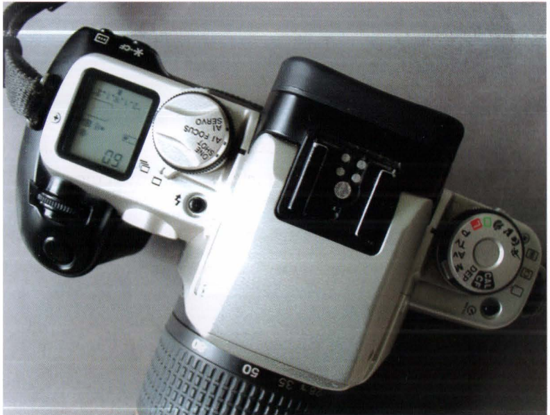
4.07 : Perde örtücünün AF fotoğraf makinesi üzerindeki LCD panelden kontrolü
