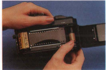
5.02 : Manuel fotoğraf makinelerine film yükleme şekli
