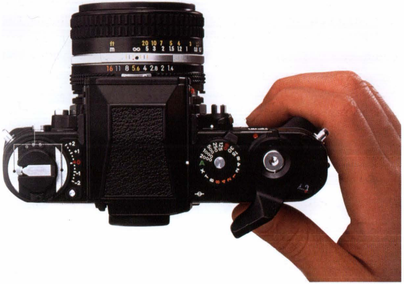
4.06 : Perde örtücünün fotoğraf makinesi üzerindeki çarktan kontrolü
