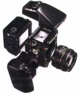
2.12 : Orta format SLR fotoğraf makinesinin açılımı
