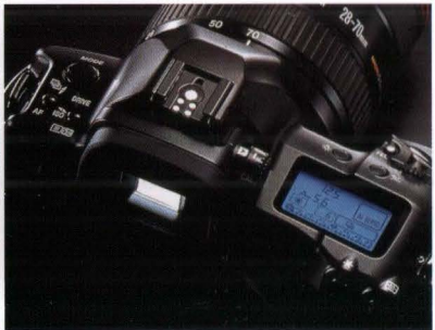
3.06 : Manuel bir objektifte diyafram kontrolü 3.07 : LCD ekrandan diyafram kontrolü
