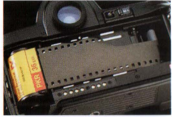
5.01 : Otomatik yüklemeli fotoğraf makinesine film yükleme şekli
