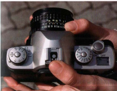
3.06 : Manuel bir objektifte diyafram kontrolü 3.07 : LCD ekrandan diyafram kontrolü
